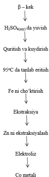
1-rasm. BARC va HZL ishlab chiqarishgan kobaltni kekdan ajratib olish texnologik sxemasi
