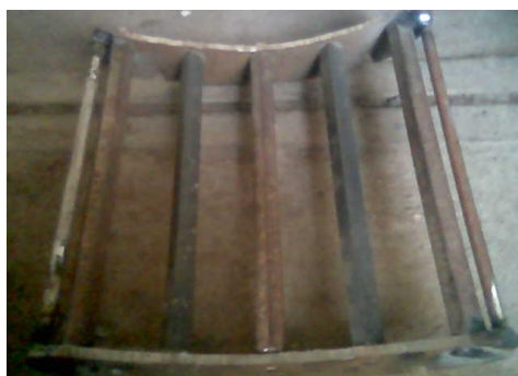
Рис.2 Общий вид колосниковой решетки с многогранными колосниками, установленные в укороченном очистителе УХК
