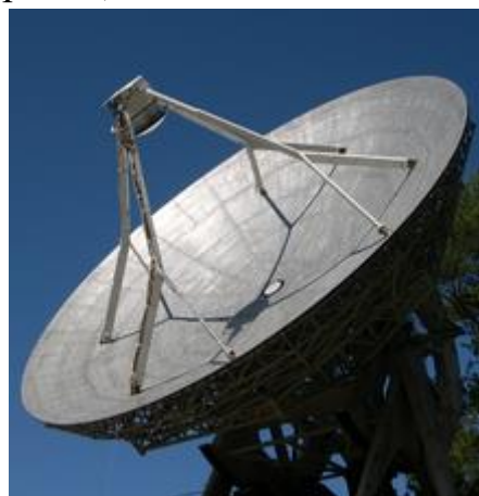
Рис. 2. Антенна радиотелескопа РТ 7.5. Диаметр зеркала 7,5 м, рабочий диапазон длин волн 1—4 мм
