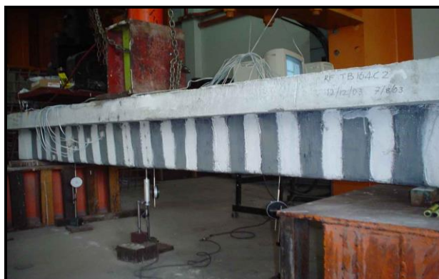
Рис. 5. Испытание тавровой балки при трехточечном изгибе ( a_v/d = 4.0 )
