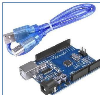
Arduino platasi, shuningdek, yuklash uchun USB kabelidan foydalanib, Arduino platasiga yangi kodni yuklash uchun ham ishlatalishi mumkin. Arduino IDE deyarli barcha shaxsiy kompyuterlarda ishlay oladigan soddalashtirilgan integratsiyalangan platformani taqdim etadi va foydalanuvchilar C yoki C++ dasturlash tillaridan foydalangan holda Arduino platasi uchun dasturlar yozishlari mumkin.
