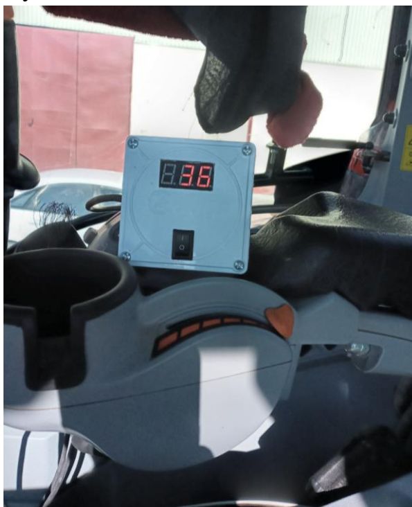
Рис.2. Показание датчика глубины вспашки в водителю для правильной контроля работы
