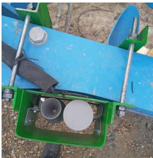
Рис.1. Установка датчика вспашки глубины и устройств передачи данных на тракторе для накопления данных в облаке
