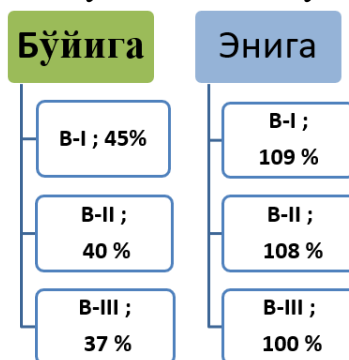
6-расм. Интерлок трикотаж тўқимасининг узилишдаги чўзилишнинг ўзгариши
