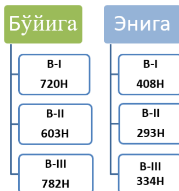
5-расм. Интерлок трикотаж тўқимасининг узилиш кучининг ўзгариши
