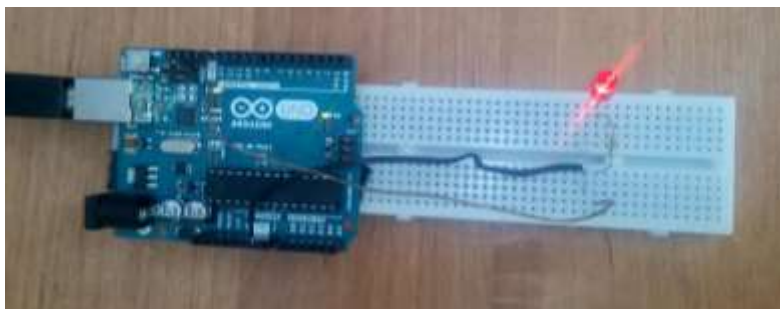
3-rasm. "Arduino UNO" qurilmasini yig'ilgan sxemaga ulash.
